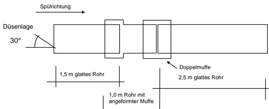
**Abbildung 2: Prüfkörper und Prüfaufbau für die dynamische Spülbeständigkeit**
